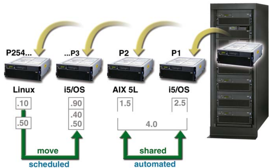
Abb. 2. Erstellung von Uncapped Partitions auf dem IBM @server iSeries i5
